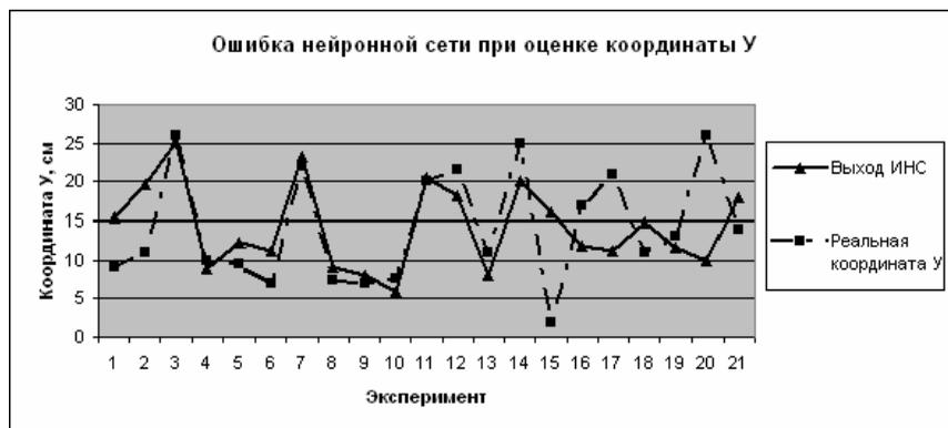
Рис. 10. Аппроксимация ошибки одометров нейронной сетью
