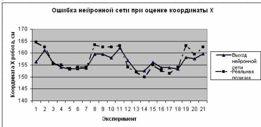
Рис. 9. Аппроксимация ошибки одометров нейронной сетью
