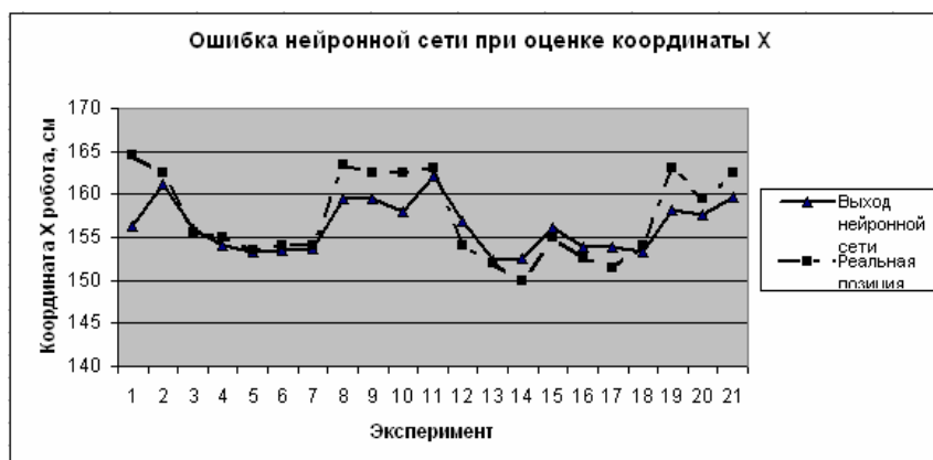
Рис. 6. Аппроксимация ошибки одометров нейронной сетью
