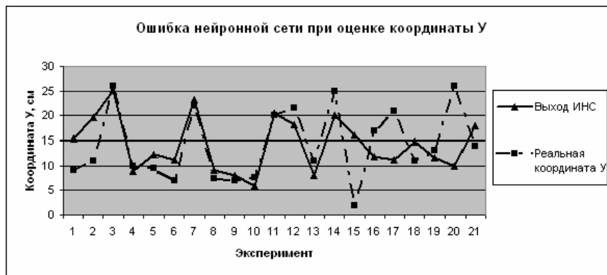
Рис. 7. Аппроксимация ошибки одометров нейронной сетью
